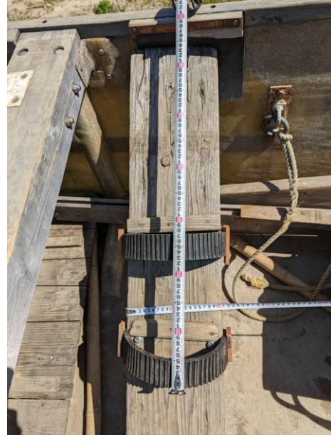
③操船足場転倒落下防止ストラップ
